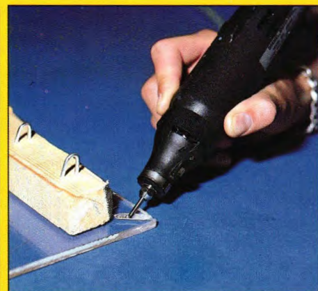
Afb. 4. Met een freesje in de boormachine of de printboormachine maken we twee groeven in de hoeken van het deksel. Hierin valt straks de luchtslang en het elektriciteits snoer, zodat het deksel goed op de bak aansluit. De houten blokjes hebben afgeschuinde hoeken zodat deze niet in de weg zitten als de luchtslang en het elektriciteits snoer naar buiten worden geleid.
